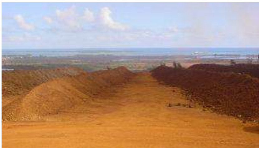
Figura 3.1. Implementación del proceso de secado natural de las menas lateríticas en Moa [9].
